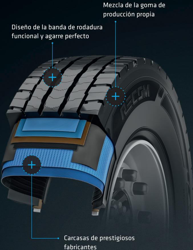
Todos los modelos y dimensiones se someten a la prueba de rendimiento RECOM 130 %, que va más allá de los requisitos legales. En este ensayo, realizado por el acreditado PRÜFLABOR NORD GMBH, el neumático funciona durante 24 horas a una velocidad de 40 km/h y con una carga de rueda del 130 % de la carga estándar en el banco de pruebas.
